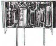
Bild 4.8 2. Oszillator; etwa in natürlicher Größe (0-857/74)
