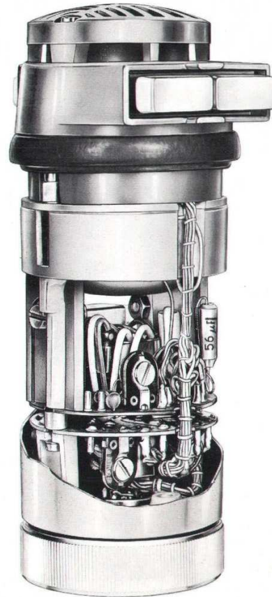
Bild 4.21 Mikrofonlautsprecher aufgeschnitten. Man erkennt den eingebauten NF-Verstärker (oben) und den Rufoszillator (unten); etwa in natürlicher Größe (3-13193)
