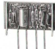
Bild 4.7 2. Mischstufe; etwa in natürlicher Größe (0-857/73)
