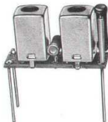
Bild 4.9 Bandfilter 455 kHz; etwa in natürlicher Größe (0-857/70)
