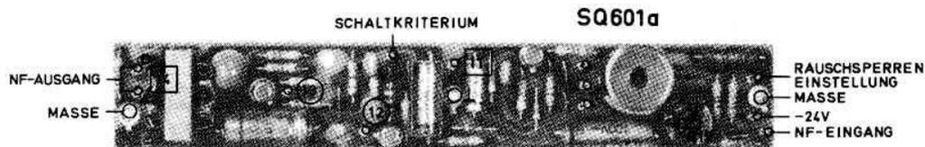
(a) Messsender an Eingangsbuchse der Baugruppe RX6x1 anschliessen und auf die Empfangsfrequenz einstellen. Frequenzhub auf 70% des Maximalwertes einstellen, d. h. auf 2,8 kHz bei 20 kHz Kanalabstand oder auf 10,5 kHz bei 50 kHz Kanalabstand. Die Modulationsfrequenz soll 1000 Hz betragen, der RF-Pegel 100 bis 1000  $\mu$ V.
