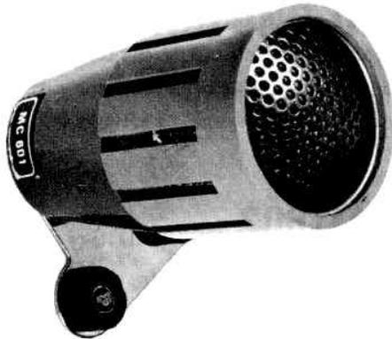
Das Mikrofon MC601a ist für feste Montage und einen Sprechabstand von etwa 30 bis 40cm bestimmt. Das Mikrofongehäuse enthält eine 600-Ω-Mikrofonkapsel und einen 50-dB-Verstärker AA604 mit integrierten Schaltungen. Dieses Mikrofon kann mit dem Bedienungsgerät CB601 zusammen benutzt werden.
