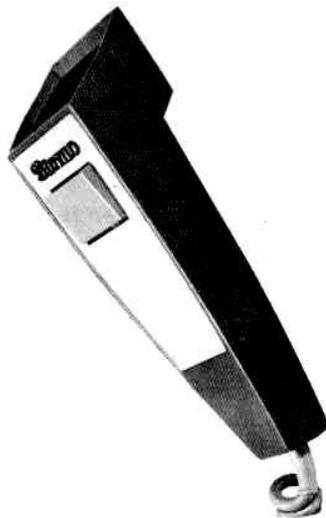
Das Mikrofon MC606a ist ein Handmikrofon mit Sprechtafel. Es enthält eine dynamische 600-Ω-Mikrofonkapsel und einen integrierten 50-dB-Verstärker.
